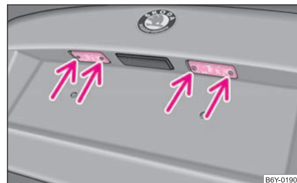
Obr. 178 Demontáž osvětlení registrační značky
