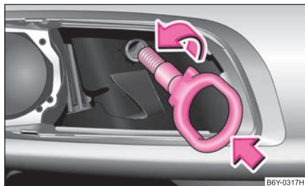
Obr. 163 Přední nárazník: montáž vlečného oka
