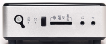
Přední strana se zapínáním, informačními diodami, čtečkou paměťových karet a 3.5 jack porty na sluchátka a mikrofon
