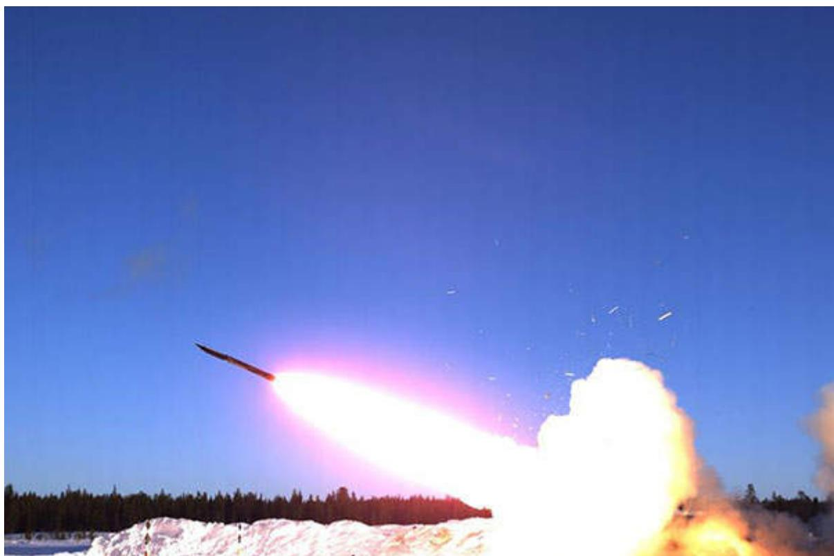
GLSDB kombinuje schopnosti vzduchem odpalované zbraně SDB I a pozemního raketového motoru M26 systému Multiple Launch Rocket System. Obrázek Copyright: Saab AB.
