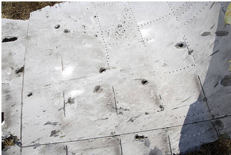
Díry po kulkách na vnějším plášti
