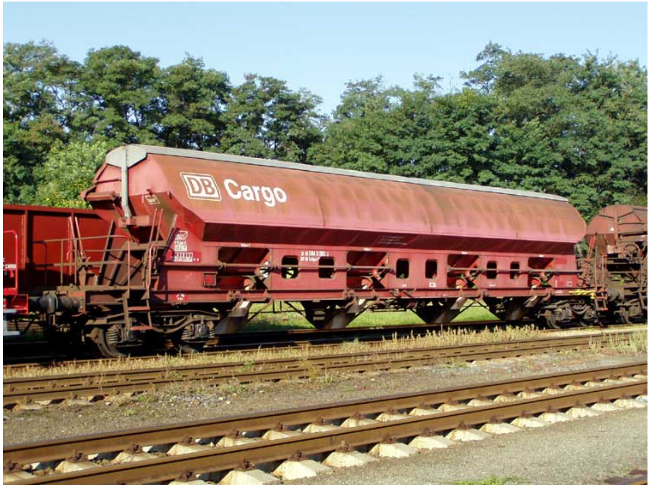
Vůz Tads-v typ 959, 31 80 084 3 002-3 ve vybledlém červeném nátěru DB Cargo, dnes Railion D
