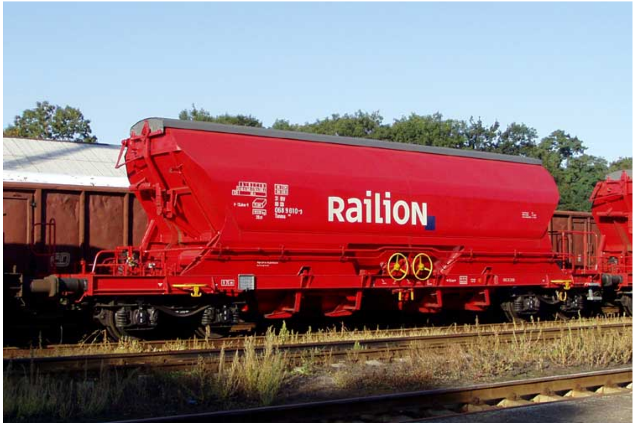
Vůz Tanoos typ 896, 31 80 0689 010-3 železničního podniku Railion D
