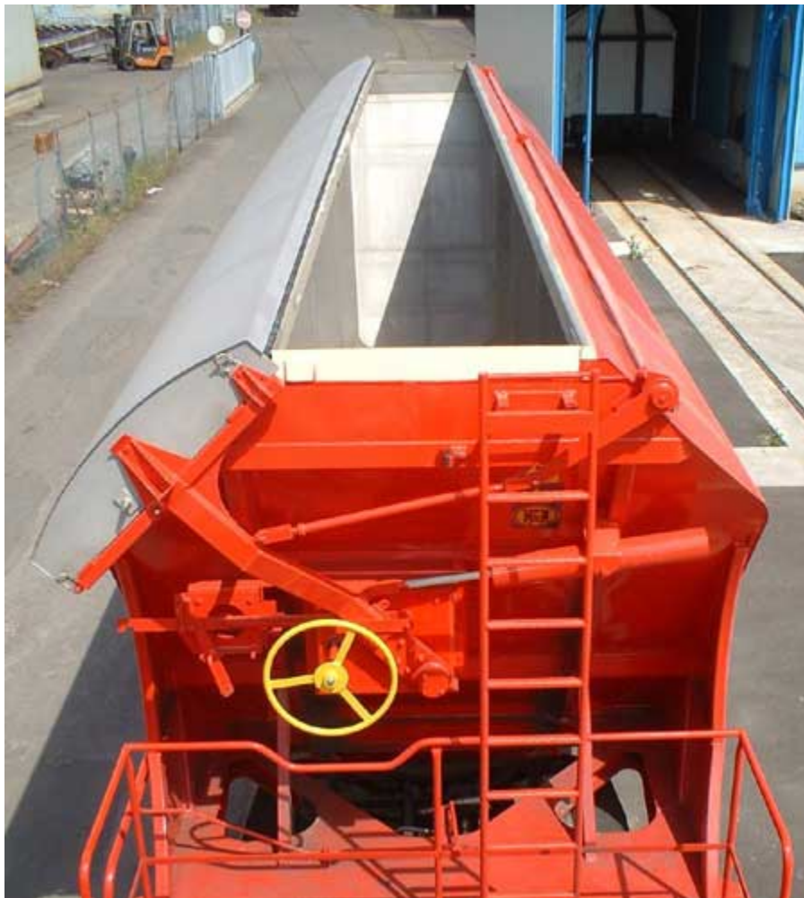
Otevřená střešní klapka vozu Tagnoos 898 - nerezová skříň (foto Graaf/Elze)
