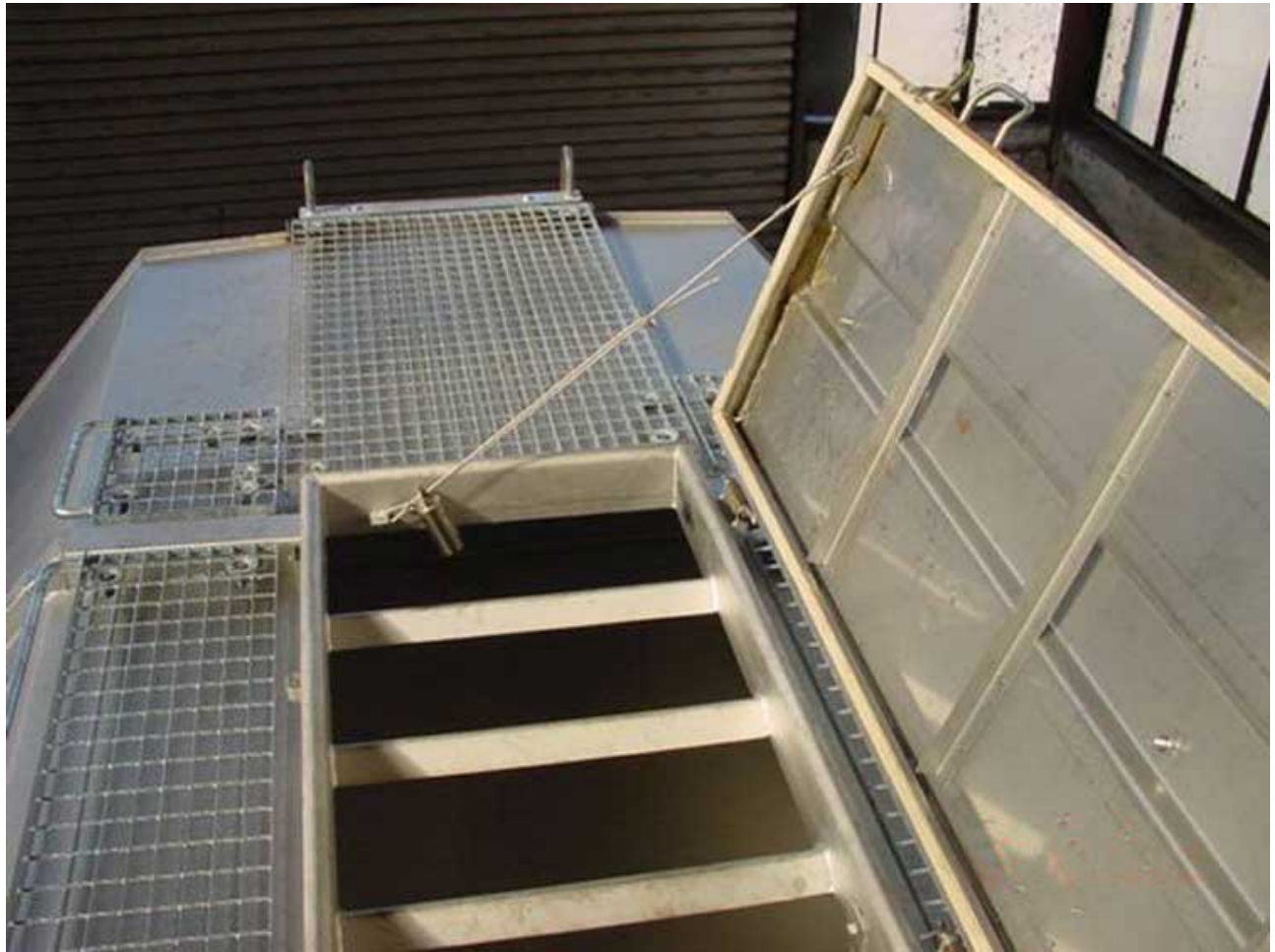
Otevřený nakládací otvor vozu Tagnpps - vše v nerezí (foto Graaf/Elze)
