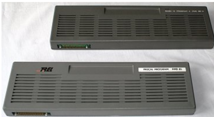
Obrázek 7: Dva moduly s paměťmi EPROM, z nichž jeden obsahoval interpret jazyka Basic-G a druhý editor a překladač Pascalu.
