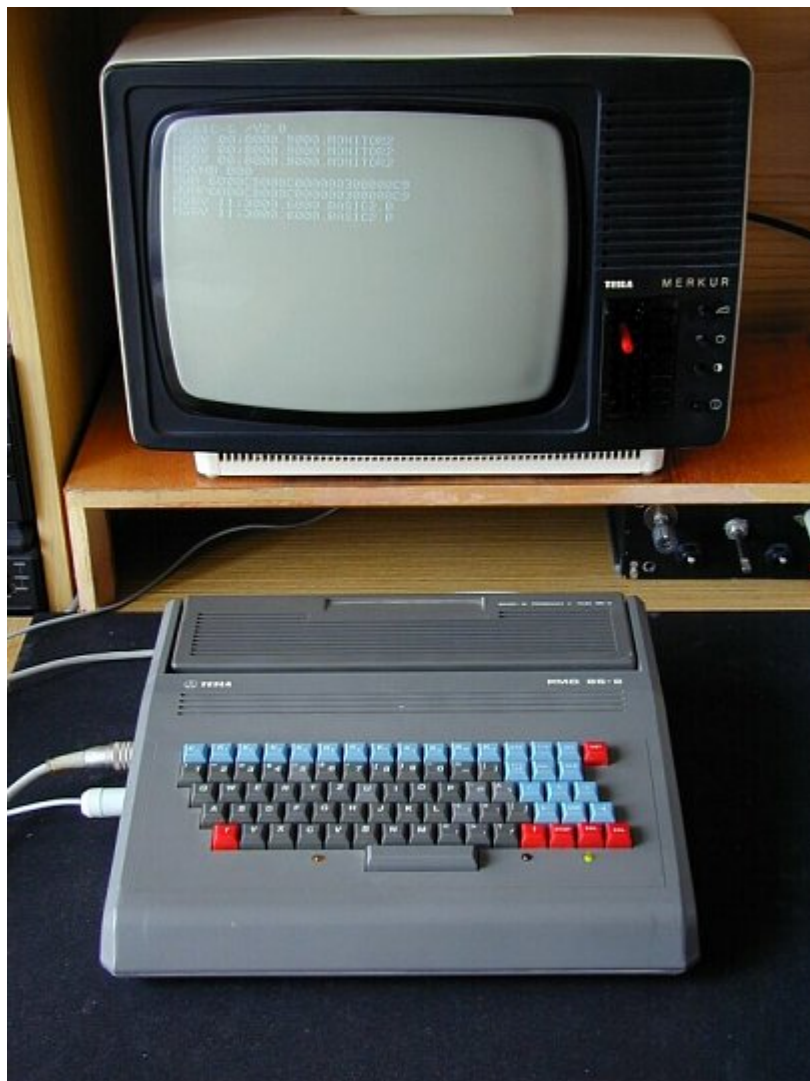
Obrázek 5: Počítač PMD 85–2 s připojeným monitorem Merkur, který byl typickou periferií používanou v ČSSR mnoha uživateli.
