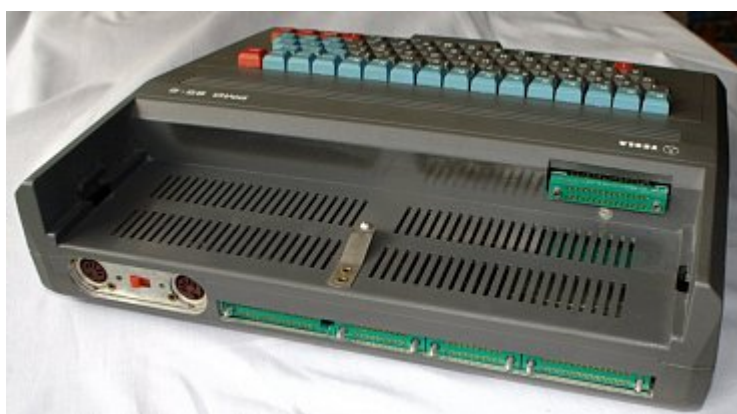
Obrázek 6: Pohled na zadní část počítače PMD 85–2 ve chvíli, kdy k němu není připojen žádný modul.
