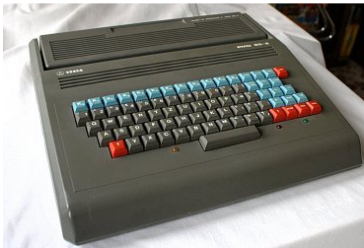
Obrázek 2: Typický počítač z kroužků výpočetní techniky: PMD 85–2.
