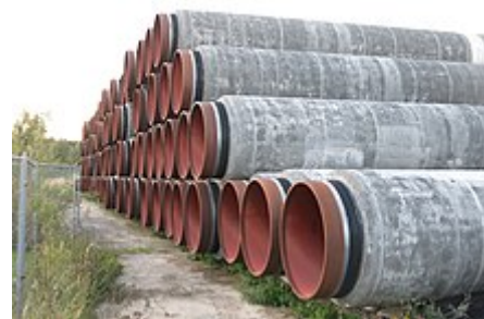
Stoh trubek, které tvoří plynovod Nord Stream 2, vyrobený z oceli s betonovým pláštěm
