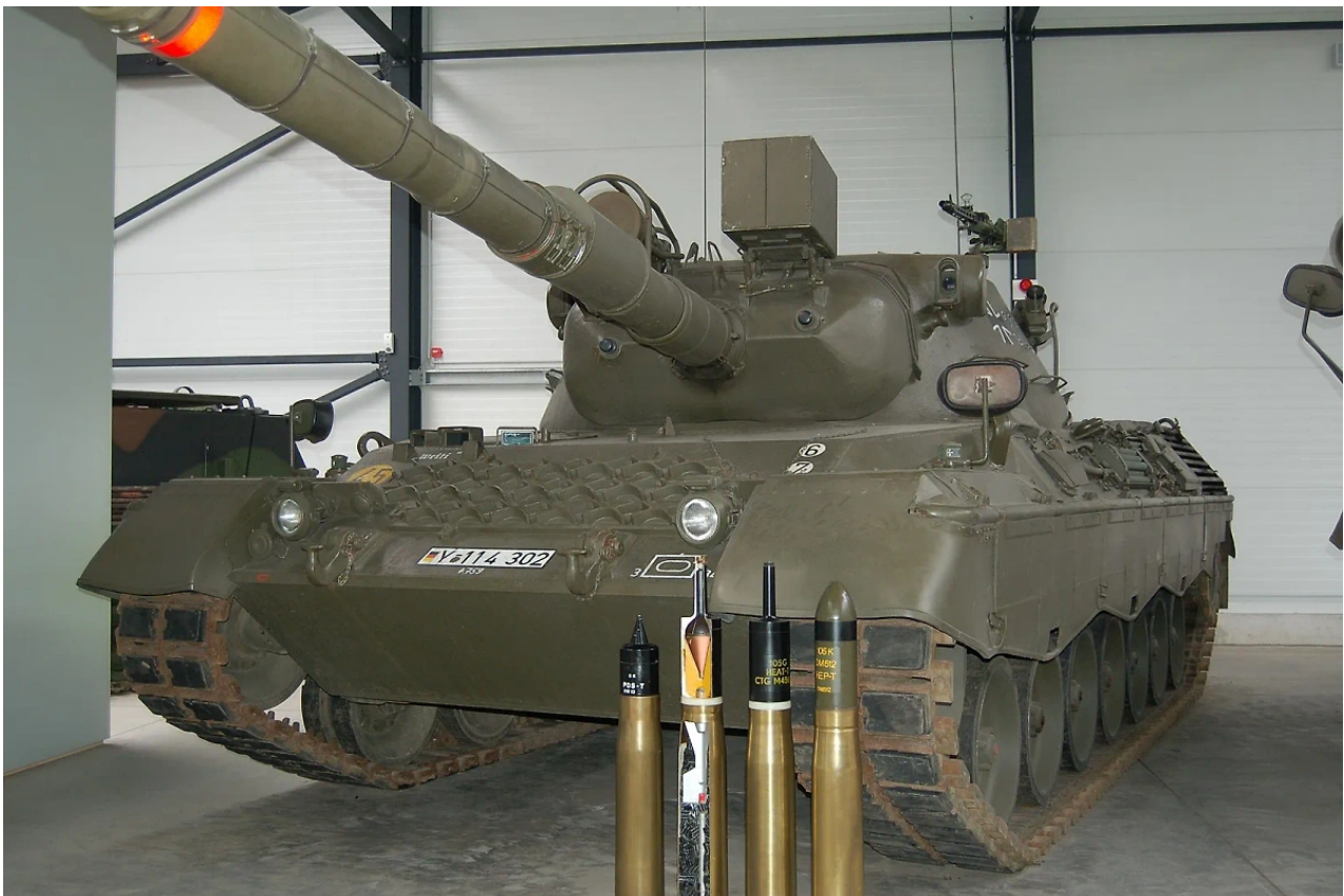
Kanón Leopard je schopen střílet municí se stabilizací v podobě ploutví. Foto © Wikipedia / Huhu
