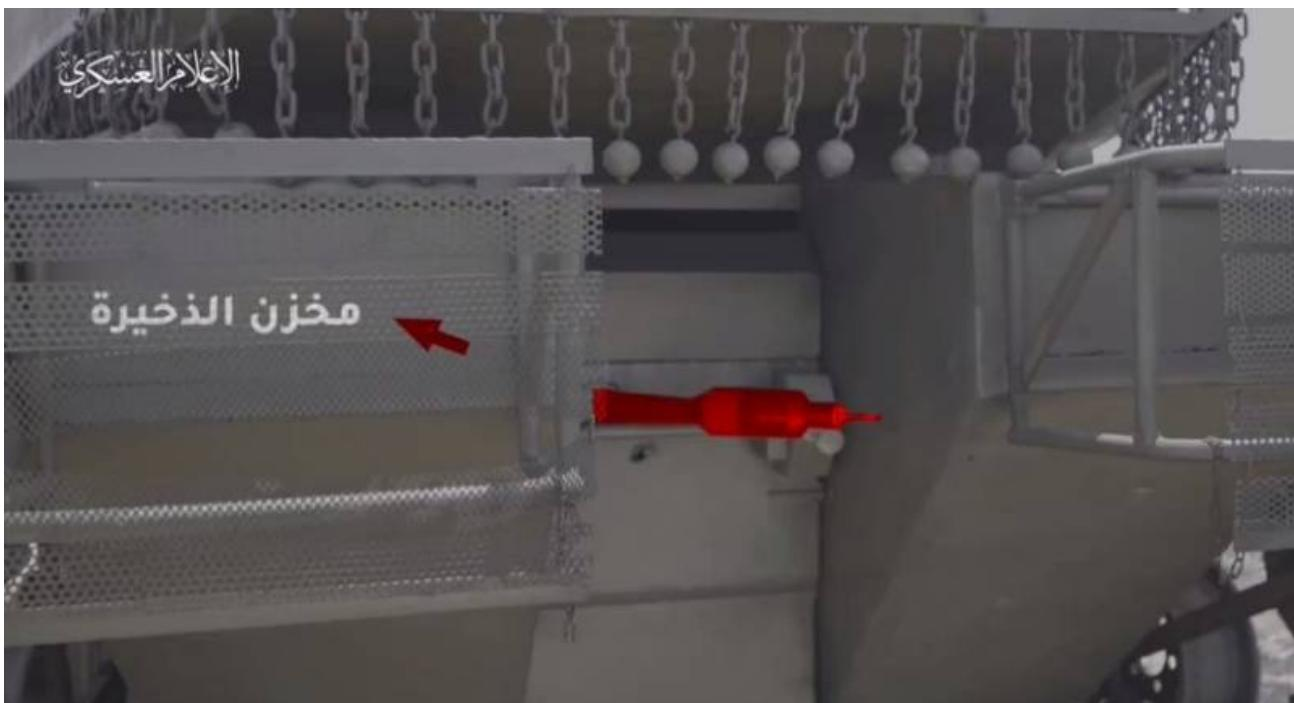
Partyzánský náboj připevněný k zadní části modelu tanku Merkava. Pro největší škodlivý účinek je náboj nakloněn ve směru muničního stojanu vozidla
