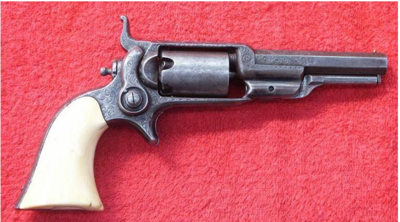
Colt 1855 Navy (nebo Root Side-Trigger Revolver), ráže .28 (7mm). Revolver je nepochybně továrně vyrytý. Existuje názor, že se jedná o zvláštní objednávku, protože o ní je velmi málo informací. Jméno "Colt 1855" je špatně zvolené. Colt získal patent na takový revolver až v roce 1855 a jeho výroba začala v roce 1856. Pro nás je ale nejdůležitější jeho gravírování...
