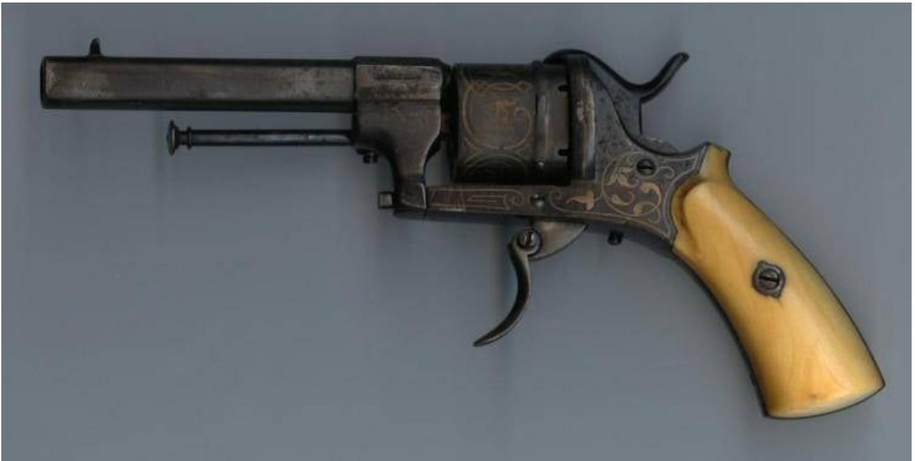
Revolver systému Lefoshe, komorový pro kolíkové náboje ráže 7 mm, šestiranný, dvoučinný, kulatá hlaveň o délce 95 mm. Slonovinové rukojeti. Výrobce nezjištěn. Tento revolver však stojí za pozornost. Je černě modřený a zdobí ho zářez z měděného drátu a kousky mědi!
