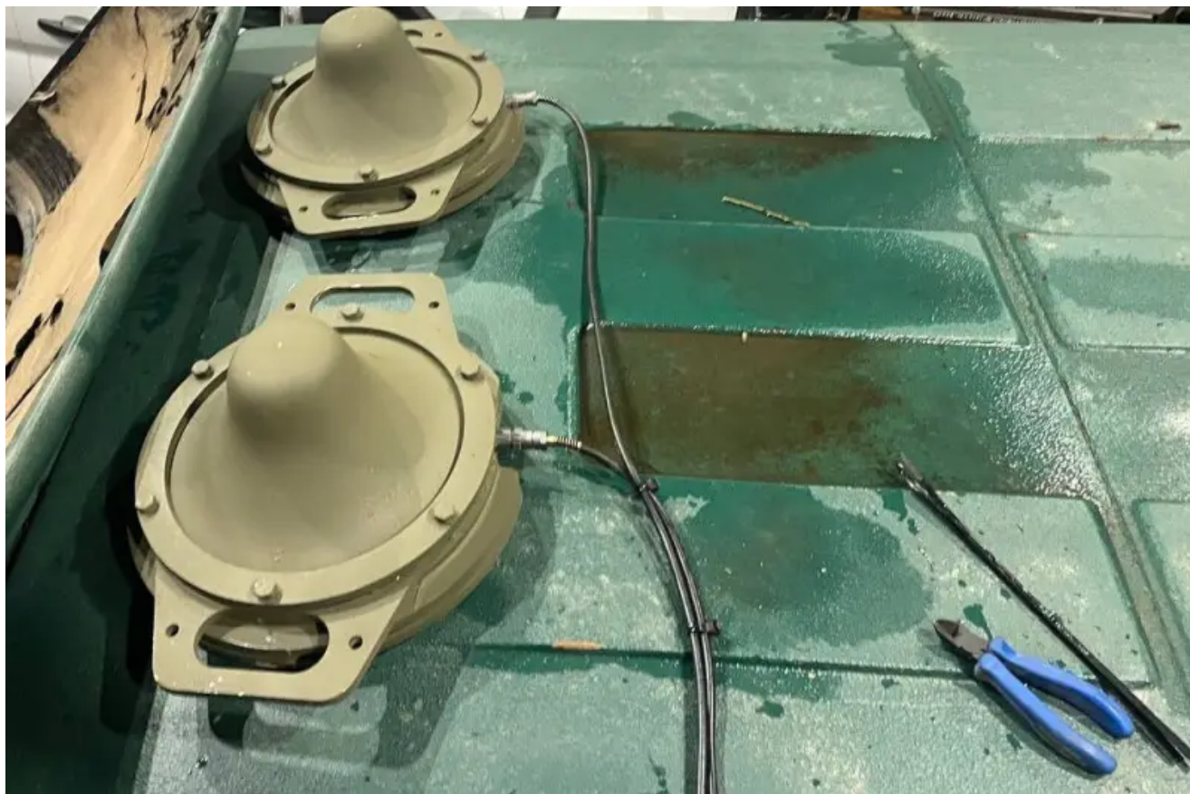
Odrušovací stanice UAV typu „Vlnolam“ na střeše automobilu. Foto KB „Volnarez“
